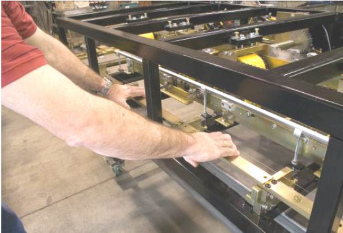
Ilustración 43: Montaje de carril derecho.
