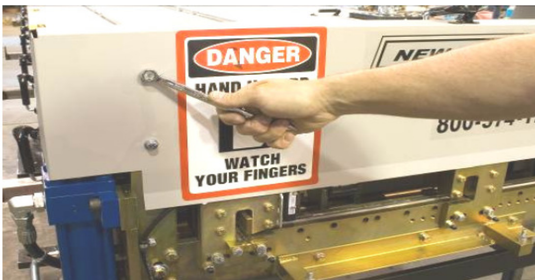
Ilustración 56: Removiendo la cubierta de cizalla.
