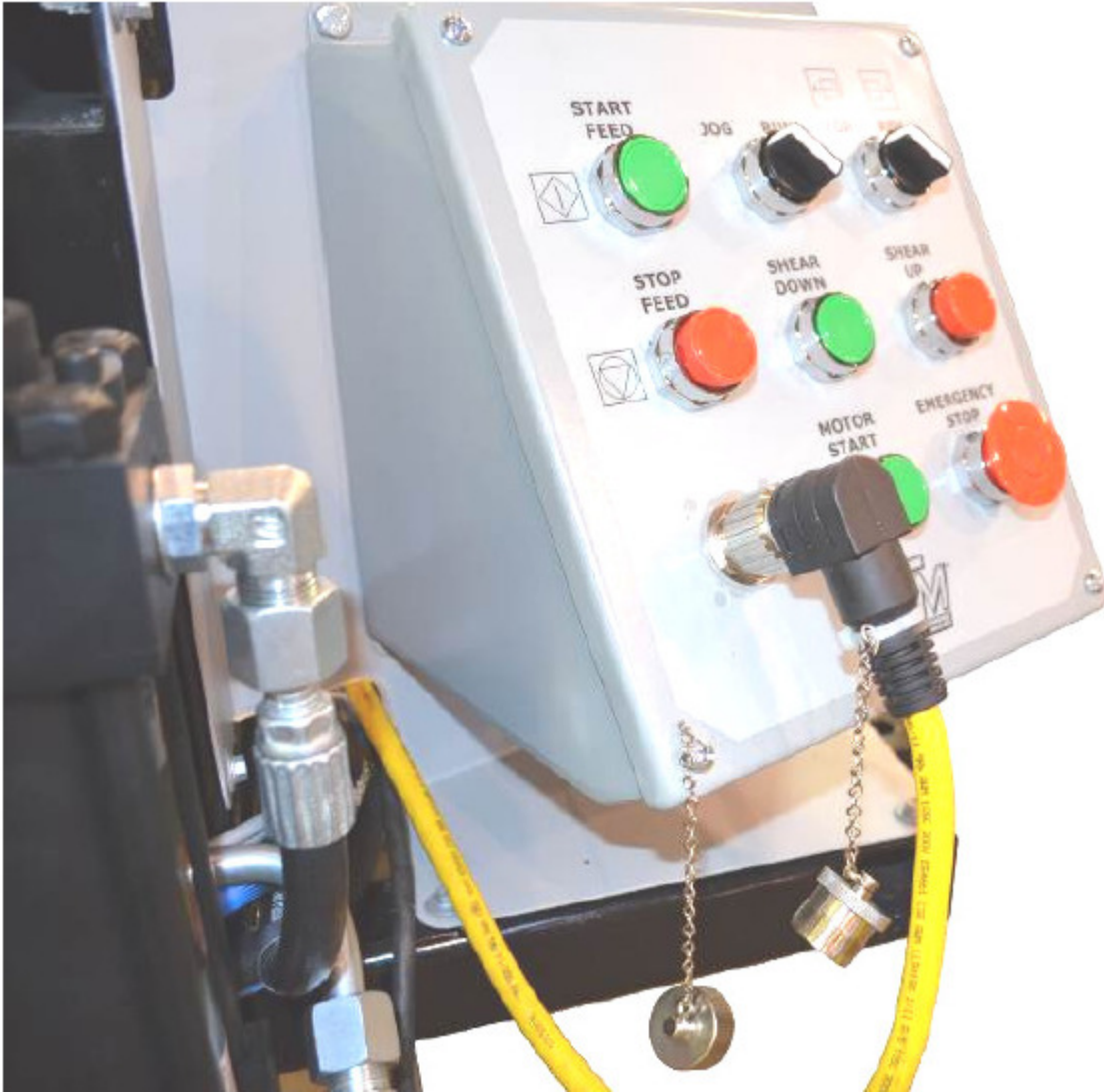
Ilustración 6: Cable de control principal.
