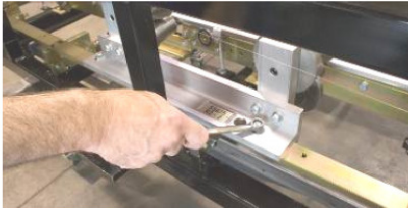
Ilustración 38: Removiendo carriles de herramientas.
